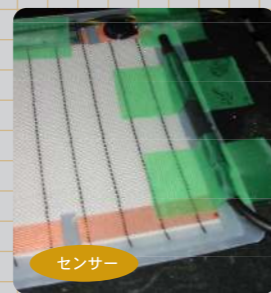
温度センサーを取り付ける。(別途降雪センサーも取付)
