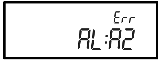
エラー表示例・・・AL:A2 （温度センサー断線）
